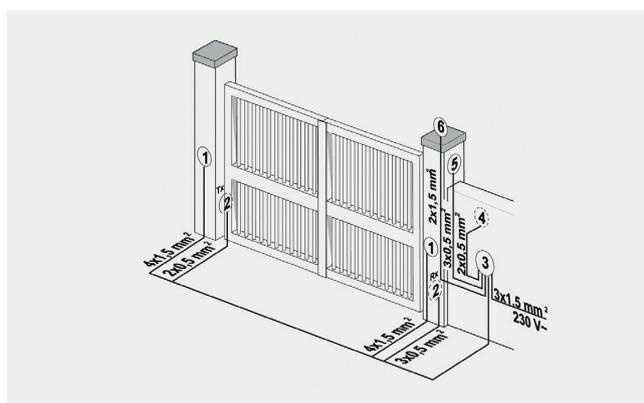
1 Antriebe 422 (2 Abzweigdosen vorrüsten), 2 Lichtschranken, 3 Antriebssteuerung, 4 Impulsgeber, 5 Funkempfänger, 6 Blinklampe
